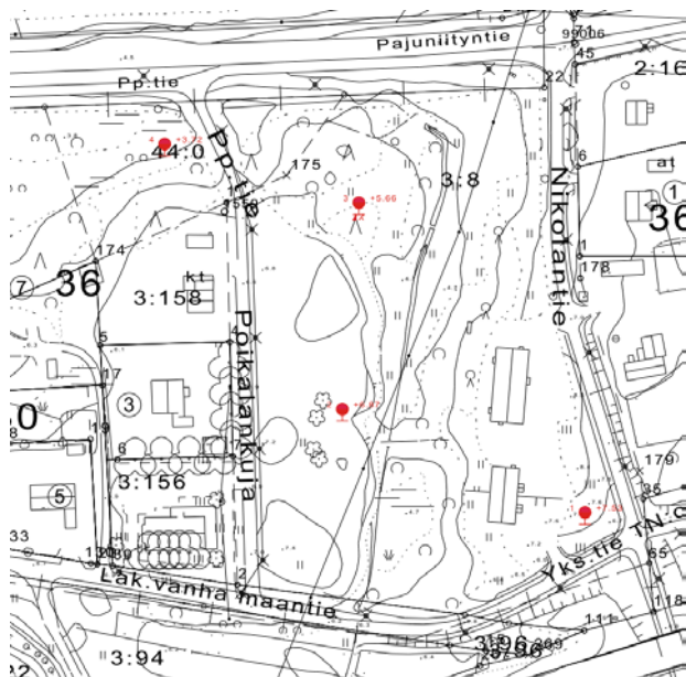
Kuva 8 Ote Geopalvelu Oy:n laatimasta maaperätutkimuskartasta (Painokairauspisteet Geopalvelu Oy 19.2.2015). Painokairauspisteiden päättymistapa on tiivis maakerros tai kallio, lohkarie tai kivi. Maaperätutkimuksen perusteella alue on hyvin rakentamiseen soveltuvaa.
