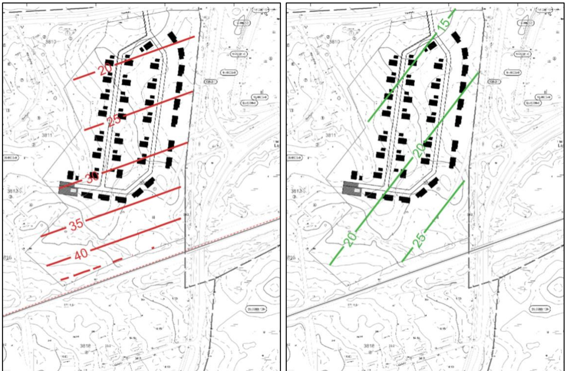
Kuvat 3 ja 4: Mallinnustulokset raideliikenteen aiheuttamasta runkomelusta kaava-alueen massoitteluluonnoksella. Pohjoinen raide (kuva 3, vasemmalla) ja eteläinen raide (kuva 4, oikealla).
