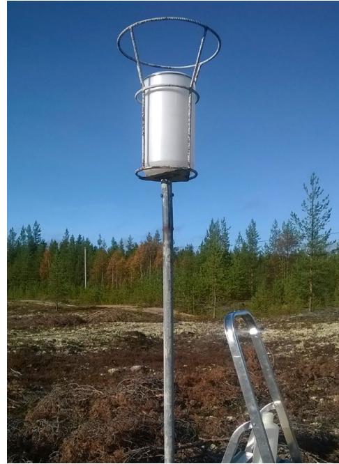
Kuva 36. Lentokentätien mittauspisteen laskeumakeräin (kuva Anu Kiviniitty).
