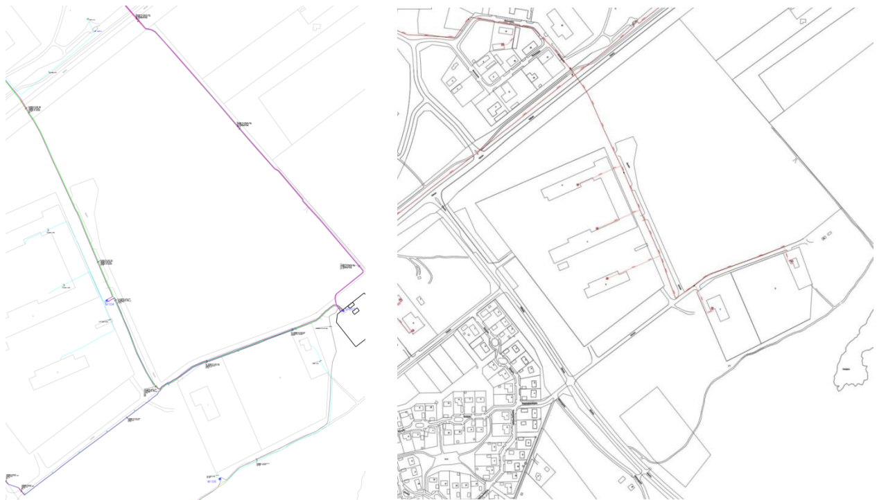
Raahen Energia Oy:n maakaapelit (oik.) sekä kaukolämpöjohdot (vas.) sijoittuvat suunnittelualueella pääosin tiealueille.
