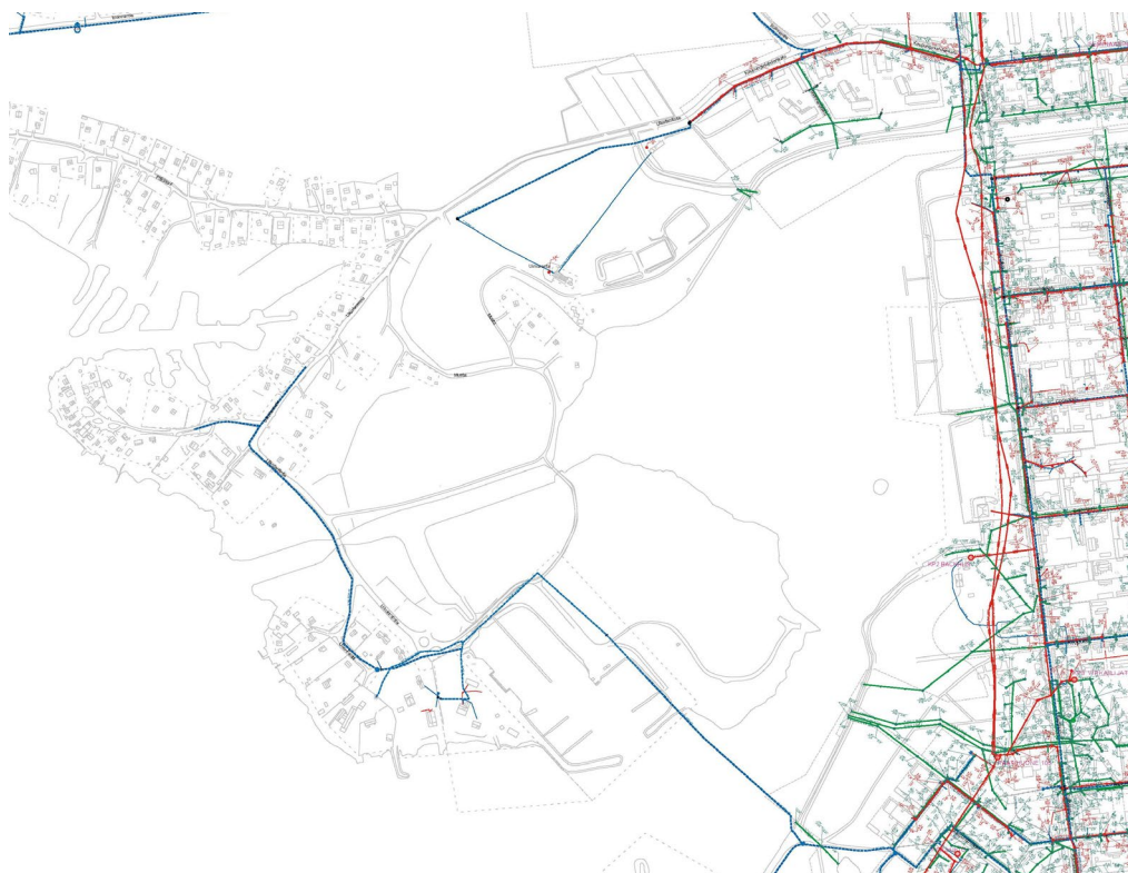
Kuva 6 Raahen Vesi Oy:n linjat Pikkulahden alueella. Jätevesiviemärit on piirretty punaisella viivalla, vesijohdot sinisellä viivalla ja sadevesiviemärit vihreällä viivalla.
