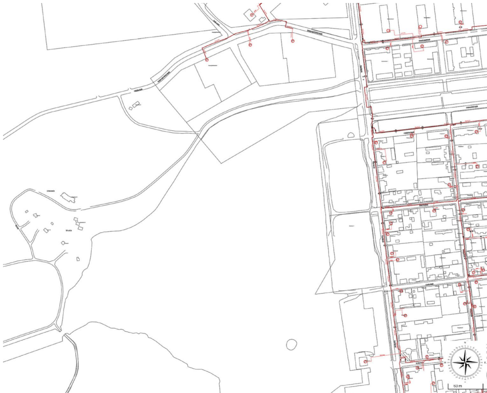
Kuva 8 Raahen Energia Oy:n kaukolämpölinjat Pikkulahden alueella.
